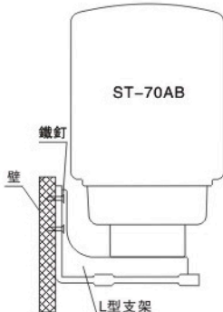
(圖5) L型支架的安裝方法
